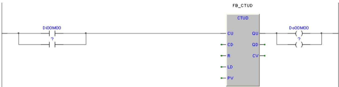
e) Puntare con il mouse linea di connessione in parallelo (Puntatore mouse diventa un doppia freccia), selezionare linea con click del mouse (La linea diventa blu). Con il tasto **Canc** eliminare riga di connessione in parallelo.
