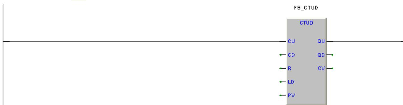
c) Ora inserire il contatto **Di00M00** sul ingresso **CU**, e la bobina **Do00M00** su uscita **QU**
