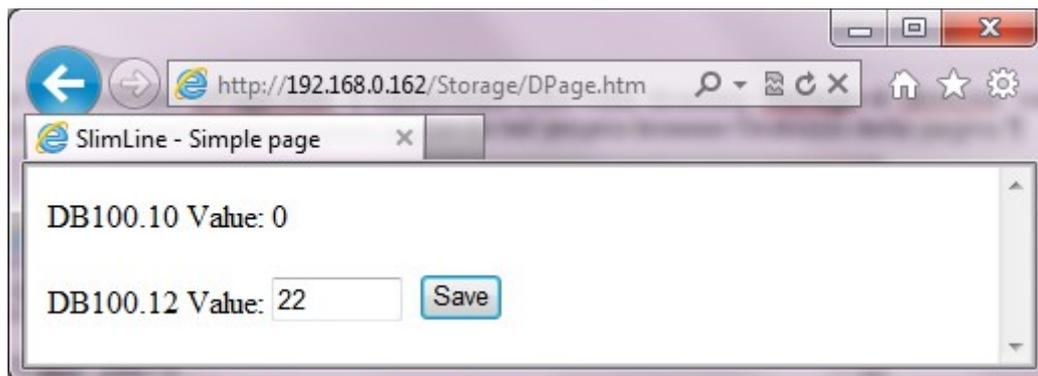
Come si vede nella riga superiore viene visualizzato il valore della variabile PLC DB100.10 mentre impostando un valore nella casella di testo della riga inferiore e agendo sul tasto **Save** sarà possibile impostare il valore della variabile PLC DB100.12.
