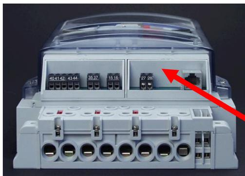
Il modulo MKMB-3-e-3 si inserisce nello slot di destra, analogamente agli altri moduli di comunicazione
