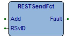
In **Add** occorre indicare l'indirizzo della stringa messaggio da inviare, eseguendo il FB il messaggio viene inserito immediatamente nel buffer FIFO di inoltro ed il client REST provvederà ad inviarlo al server appena possibile.
